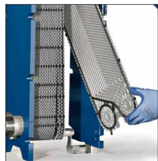
Einfache und präzise Plattenpositionierung
